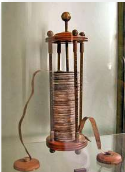
Replica of Volta's first battery ("Voltaic Pile") Museum Tempio Voltiano.
